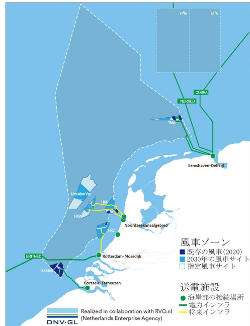
図4 オランダの 2030 年の北海における洋上風車のため方針。12 海里(約 22.2km)の風車の立地を制限している。(出典: 参考文献 12)
